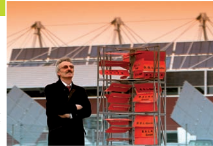
Ö.Ö.L.-Quelle: »Vertikal und horizontal dem Wind entgegen: Klaus-Dieter Balke entwickelte eine neuartige Windkraftanlage aus einem Stahlrahmen mit integrierter Vertikal-Achse und Rotorblättern auf Horizontalachsen.«
